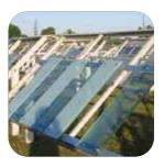
**Planar**<sup>™</sup> | SentryGlas<sup>®</sup> Plus System *panels on test in Florida.*
